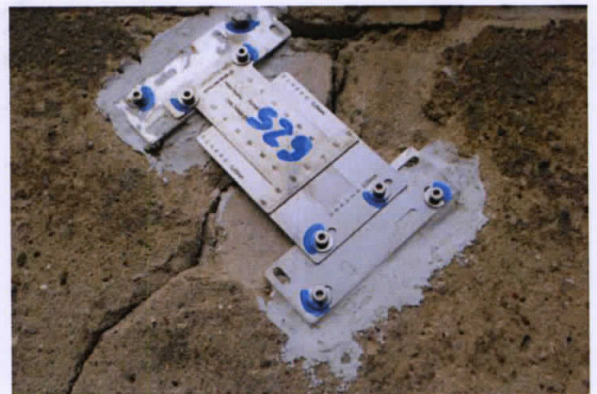
Fot. 25-30. Pary pomiarów zmian szerokości rozwarć pęknięć ścian, stan w czerwcu (po lewej) i w grudniu 2014 r. (wskaźnikami NeoStrain założonymi przez budowniczych galerii).
