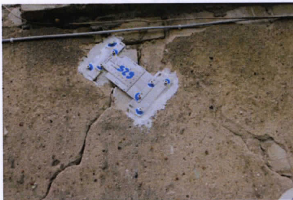
Fot. 25-30. Pary pomiarów zmian szerokości rozwarć pęknięć ścian, stan w czerwcu (po lewej) i w grudniu 2014 r. (wskaźnikami NeoStrain założonymi przez budowniczych galerii).
