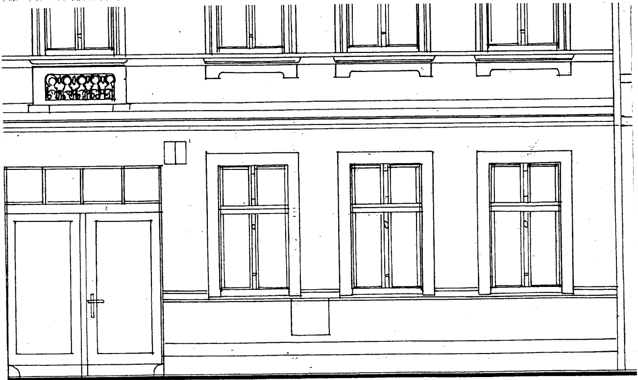
widok po rekonstrukcji dwu okien parteru 1:50
